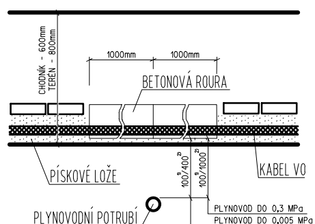
KŘÍŽENÍ KABELU VO A PLYNOVODU
